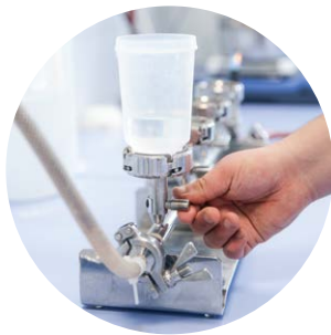
Apparatur für die Membranfiltration in der Mikrobiologie
